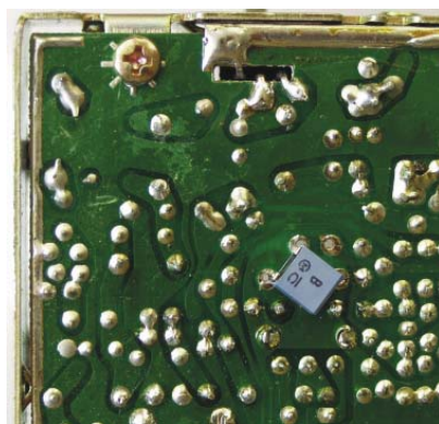
Obr. 3. Keramický filtr muRata SFGCG455-BX-TC v provedení SMD
